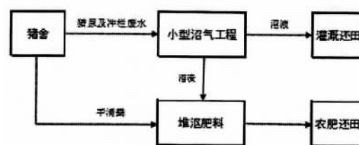
图1 水肥还田模式工艺流程图
